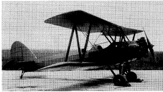
【写真①】九五式三型練習機。胴体に2本線が見え、試作2号機と推測される。本機の特徴でもある尾輪が見て取れる。
