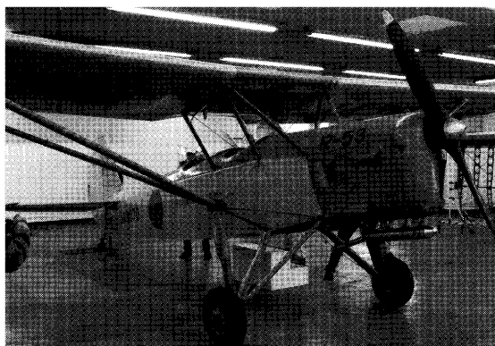
復元後のR-53（2014年4月、筆者撮影）。プロペラは、操縦席から見た反時計回りであることが分かる。
