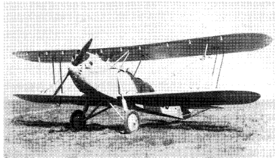
下は、上翼全幅にスラットを装備した石川島社有機のR3 (J-BDEB)。
