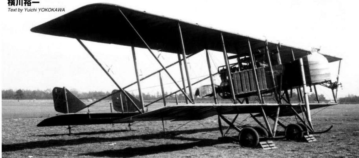
モ式六型336号機。大正10年の製造年は読めるが、製造月はパイプに隠されて見ることができない。機首の風車型発電機(一羽式)、操縦席の向こう側に風板式速度計が見える。機首右側面から下方に伸びている白いものは、爆弾投下用の筒。
