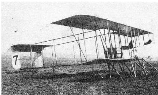
【写真1】 改造によって、前方昇降舵と後下方の水平尾翼が廃止された、モ式1913年型7号機(当時の絵葉書から)。
