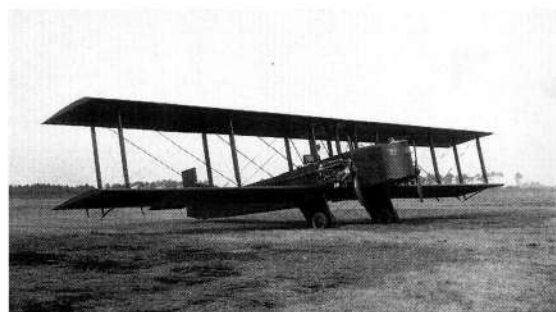
【写真5】 ロレーヌ400馬力搭載の丁式二型爆撃機。張り出した補助翼はスッカリし、方向舵が増殖された。また、夜間飛行用に暗色に塗装された。
