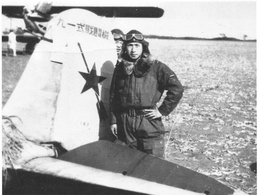
写真6. クッキリとした「星に矢」が印象的な一葉。綺麗な方向舵、彩色された昇降舵、対照的に薄汚れた安定板にも注目。安定版のホーン部にあるのは空中線取り付け基部で、写真3でも確認できる。
