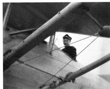
写真6. 補強材の取り付けが分かる主翼支柱部分。(写真提供: 柳沢光二)
